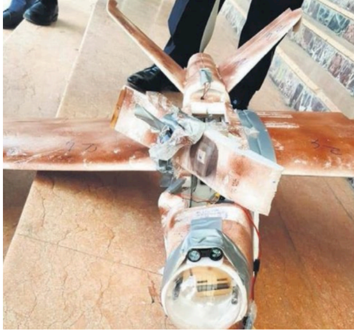
10 Kasım 2018 Atatürk'ü anma etkinlikleri sırasında 09.15 civarında Şırnak Valiliği'ne düşen sabit-kanatlı, planör tipi gövdeye sahip drone. Önceki örneklerden farklı olarak, uzaktan kumanda edilmediği, önceden koordinat bilgilerinin girilerek, GPS-tabanlı navigasyon sistemi ile uçurulduğu ve sınır-ötesinden fırlatıldığı belirtilmektedir 5 .
