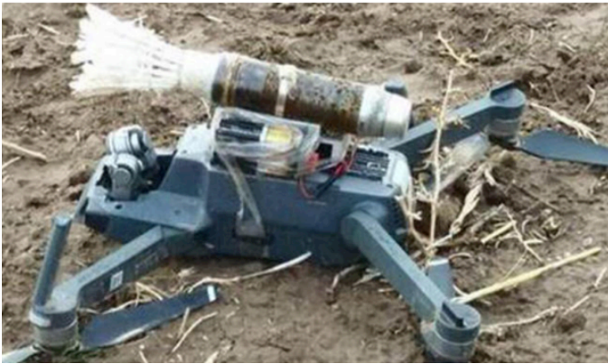
Ağrı'da ele geçirilen (2017) döner-kanatlı drone. Mühimmat olarak tüfek bombası taşıdığı görülmektedir 4 .
