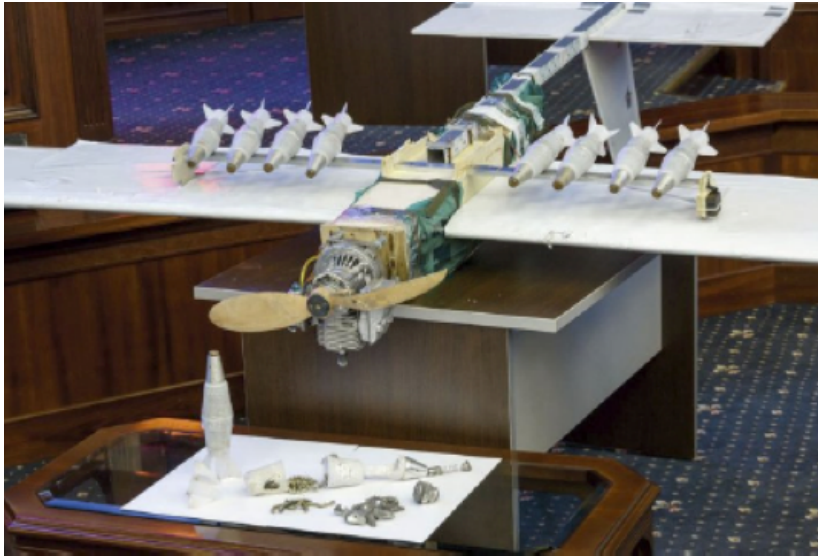
Rusya Federasyonu Savunma Bakanlığı tarafından saldırı sonrasında sergilenen örnek drone. Başaşağı şekilde duran platformun altında kullanılan EYP mühimmata dikkat çekilmektedir 22 .
